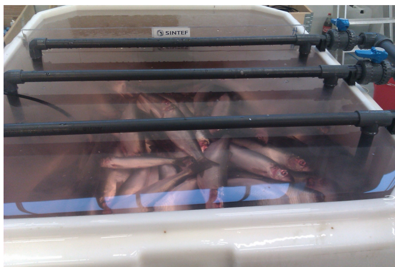
Figur 7: Figur som tydelig viser oppstrømning langs sidene i karet (klart vann i midten) (SINTEF, 2011)
